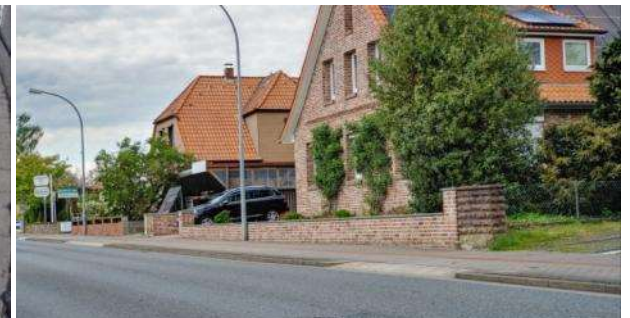
Höhengleich geführter Radweg im Bereich von Zufahrten
